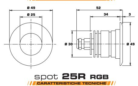
Corrente nominale 350 mA DC Potenza assorbita 3 led 3,6 W Corpo faro acciaio inox Anello flangia acciaio inox Diffusore in vetro temprato sp. 6 mm. Resistenza al carico 1000 Kg Grado protezione IP68 Temperatura ambiente -30° C • +50° C Peso 100 a
